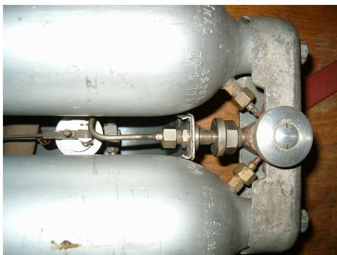
Výstup dýchacího média ( používal se jak vzduch tak kyslík) provrtanou lahví u hrdla. V závitech v hrdlech jsou pouze šrouby, které drží kryt.
