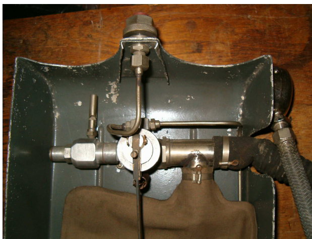
Automatika přístroje Prometheus. ( vlevo od ní je píšťala výstražného signálu)
